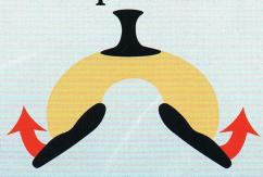
Unser neu entwickelter ScapuFlex® (Pat. angem.) Sattelbaum ist so konstruiert und gefertigt, dass die Bars vorne weicher sind und bei stärkerer Druckbelastung ausweichen können.
